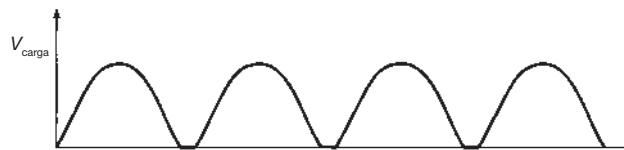
FIGURA 1.59 Tensão de saída de onda completa (sem filtro).
