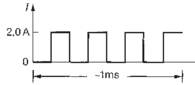
FIGURA 1.64 Ilustração do aquecimento I^2R maior com fluxo de corrente descontínuo.
