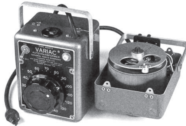
FIGURA 1.129 Um transformador variável para rede elétrica (“Variac”) permite ajustar a tensão de entrada CA para um valor de teste. Aqui é mostrada uma unidade de 5 A, tanto com o gabinete fechado quanto aberto.
