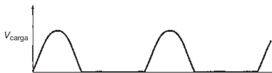
FIGURA 1.57 Tensão de saída de meia-onda (sem filtro).
