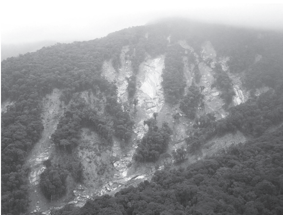
Fig. 1.1 Escorregamentos planares associados a taludes infinitos
