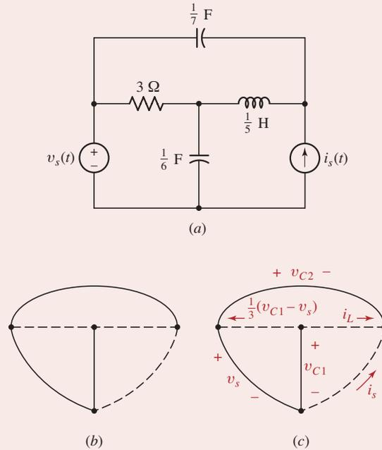
▲ FIGURA 19.4 (a) Um dado circuito para o qual devemos escrever equações na forma normal. (b) Apenas uma árvore normal é possível. (c) Tensões de ramo de árvore e correntes de elo são assinaladas.
