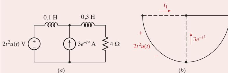
▲ FIGURA 19.7 (a) Circuito para o qual uma árvore normal não pode ser desenhada. (b) Desenha-se uma árvore na qual um indutor deve ser um ramo de árvore.
