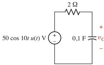
▲ FIGURA 19.12 Circuito de primeira ordem para o qual a tensão  $v_C(t)$  deve ser determinada usando-se os métodos da análise por variáveis de estado.
