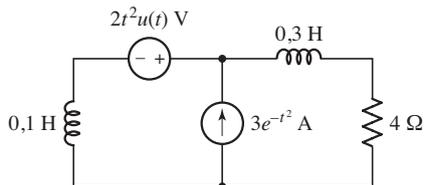
▲ FIGURA 19.8 O circuito da Figura 19.7a é redesenhado de forma a fazer o supernó contendo a fonte de tensão ser conectado ao restante da rede apenas através dos dois indutores e da fonte de corrente.
