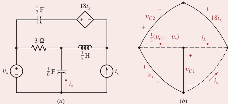
► FIGURA 19.6 (a) Circuito contendo uma fonte de tensão dependente. (b) A árvore normal para este circuito com as tensões de ramo de árvore e as correntes de elo atribuídas.
