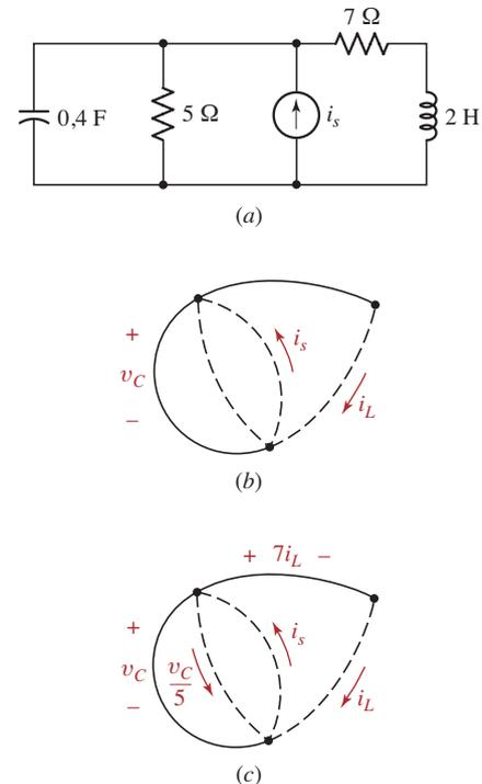
▲ FIGURA 19.2 (a) Circuito  $RLC$  requerendo duas variáveis de estado. (b) Uma árvore normal mostrando as variáveis de estado  $v_C$  e  $i_L$ . (c) A corrente em cada elo e a queda de tensão em cada ramo de árvore são expressas em termos das variáveis de estado.
