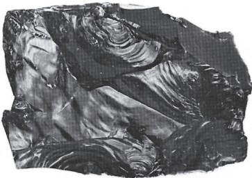
Fig. 1.1 A obsidiana é um vidro natural de origem vulcânica com característica fratura conchoidal ou concoide. Muitos minerais e rochas apresentam esse tipo de fratura
