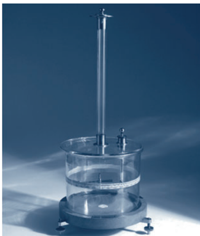
Uma reprodução do século XIX da balança de torção de Coulomb.
